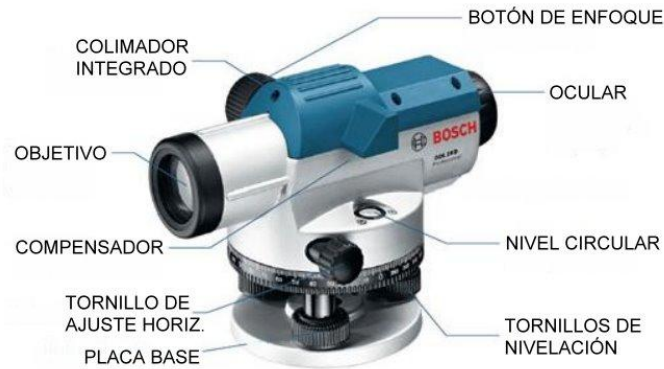
Ilustración 6.- Partes de un nivel óptico
