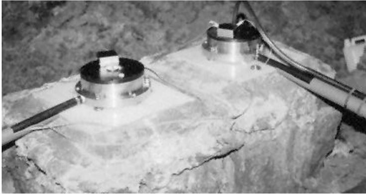
Fig. 14: Clinómetros de larga base (WT, Water Tube) instalados en el interior de la Cueva de los Verdes, siguiendo direcciones perpendiculares.
