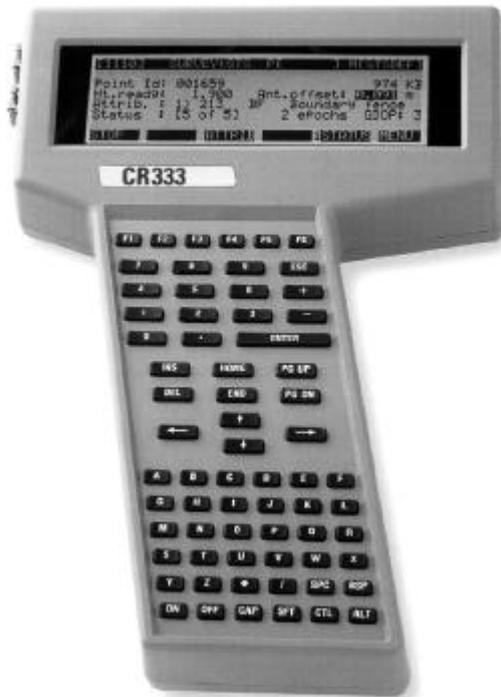
Fig. 35: Unidad de control para GPS. Permite al usuario utilizar el sistema.
