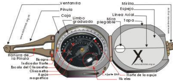
Ilustración 2.- Partes de una brújula
