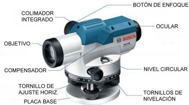
Ilustración 6.- Partes de un nivel óptico
