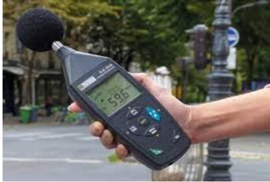
Figura 12. Sonómetro.<sup>[4]</sup>
