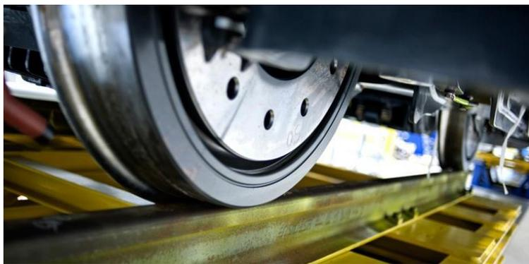
Figura 18. Ruido de rodadura, interacción entre la rueda y el riel.<sup>[7]</sup>
