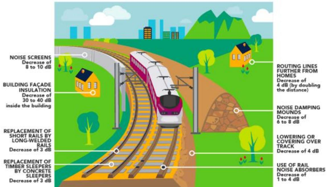
Figura 24. Medidas para reducir el ruido ferroviario.<sup>[6]</sup>
