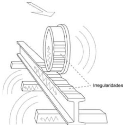
Figura 2.5. Ruido de rodadura. Interacción entre la rueda y el riel.
