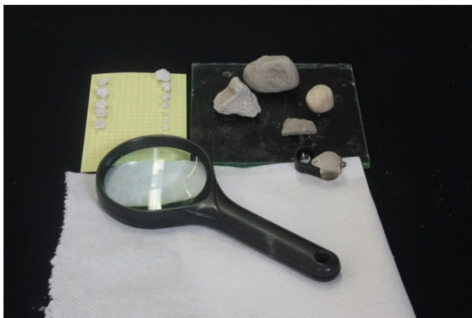
Figura 2. Identificación de suelos gruesos por su tamaño
