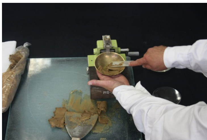
Figura 6. Colocación del material en la copa.
