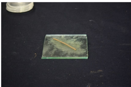
Figura 14. Cilindro sin agrietarse.
