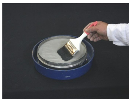
Figura 11. Limpiado con brocha la malla No. 200.
