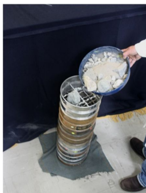
Figura 4. Vaciado de material en el sistema de mallas
