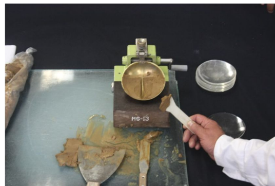
Figura 8. Ranura en el material.
