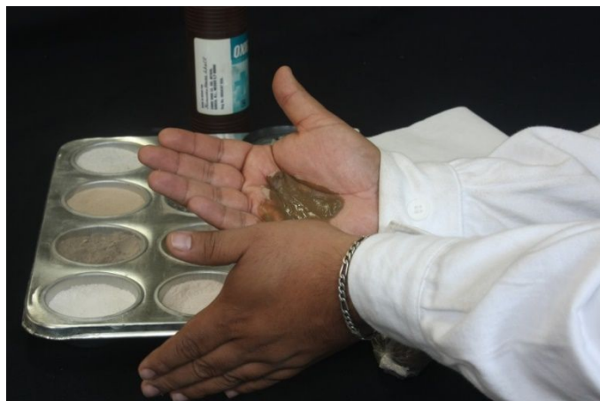
Figura 4. Prueba de dilatancia
