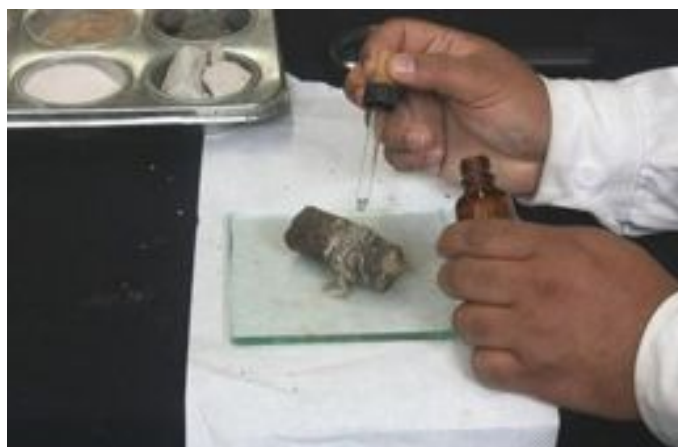
Figura 8. Muestra orgánica con agua oxigenada
