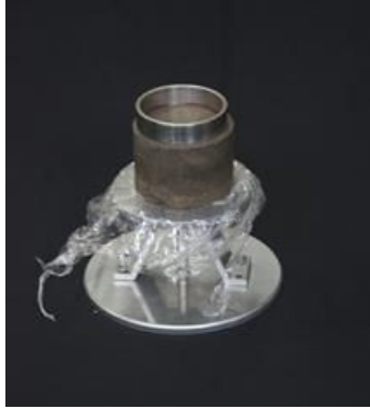
Figura 8. Anillo centrado en muestra.
