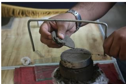
Figura 12. Corte de enrasado.
