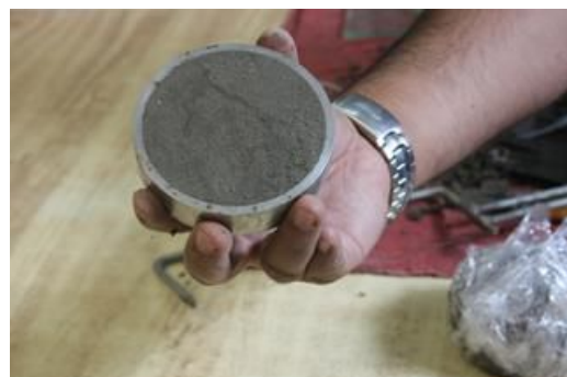
Figura 13. Muestra dentro de anillo.
