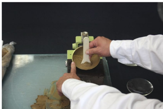
Figura 7. Colocación del ranurador
