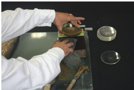
Figura 9. Limpieza de la base de la Copa de Casagrande.
