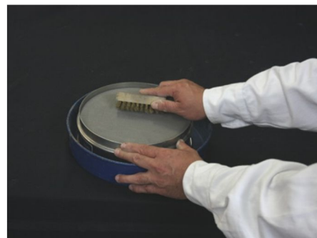
Figura 10. Liberando material atrapado.
