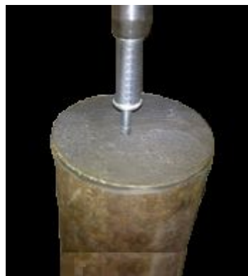
Figura 6. Prueba de penetrómetro de bolsillo.
