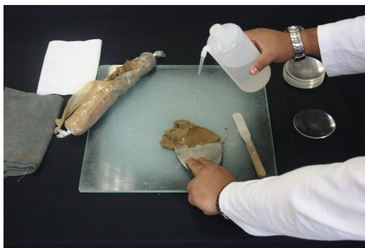
Figura 5. Remoldeo e hidratación del material.
