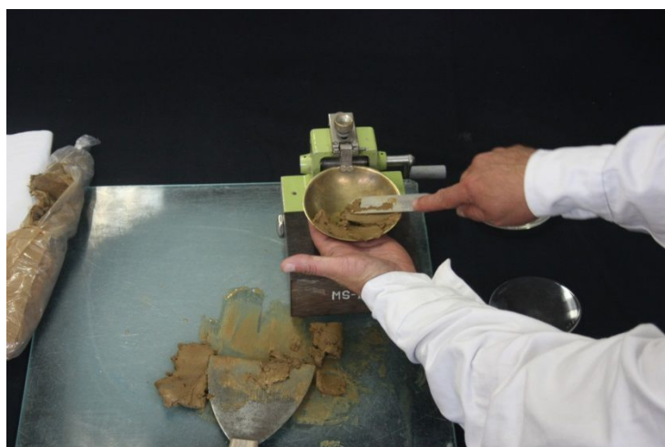
Figura 6. Colocación del material en la copa.
