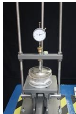
Figura 18. Montaje en consolidómetro.
