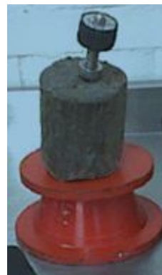
Figura 5. Prueba de torcómetro de bolsillo.
