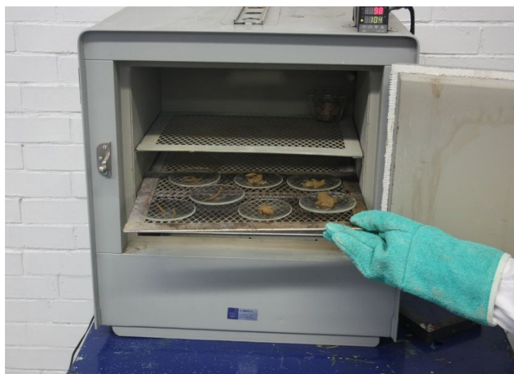
Figura 16. Muestras de suelo para secarlas al horno.
