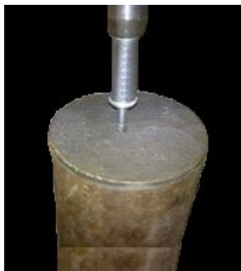
Figura 4. Prueba de penetrómetro de bolsillo.
