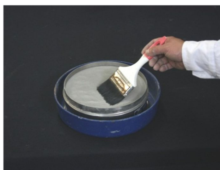
Figura 11. Limpiado con brocha la malla No. 200.
