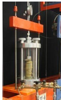
Figura 3. Probeta Falla.
