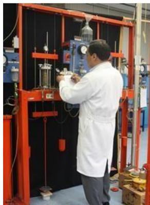
Figura 2. Registro del extensómetro.
