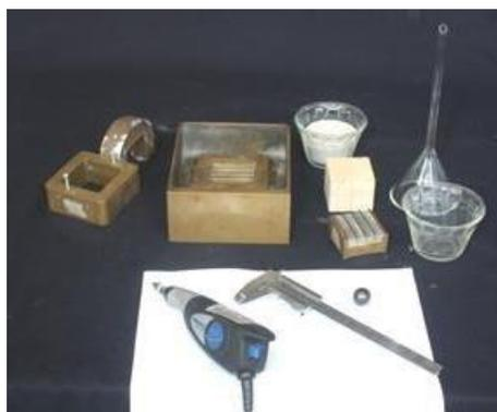
*Figura 6. Equipo para formar probeta*
