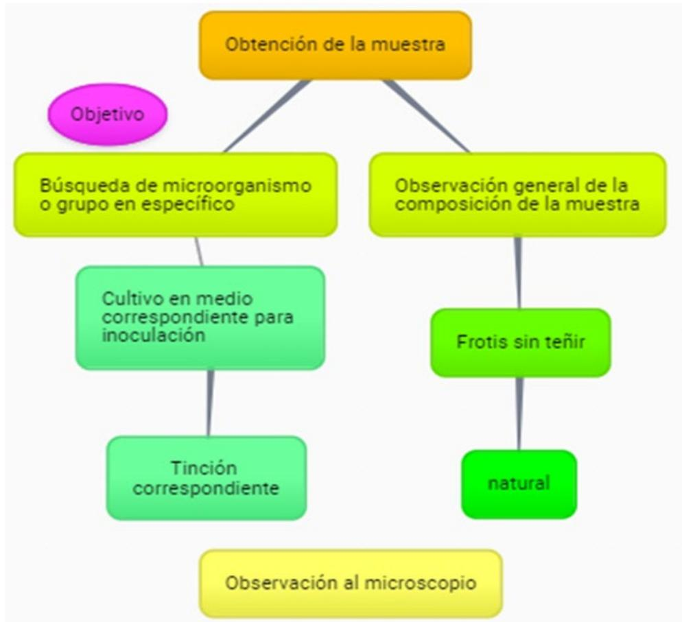
Fig. 1.4 Resumen de los procedimientos previos a la observación en el microscopio de acuerdo con el objetivo de estudio.
