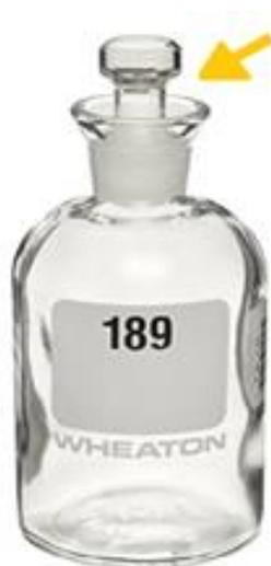
Figura 6.1 Frasco Winkler y espacio donde se debe colocar el sello hidráulico.
