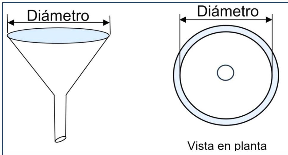
Figura 1. Indicación de las medidas a registrar del embudo.
