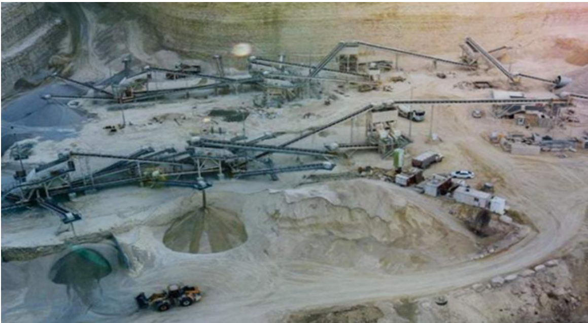
Figura 5.2 Vista aérea de una planta trituradora de gran capacidad (600 ton/h). Fuente: https://www.mekaglobal.com/upload/files/27-05-2020_74255_03--soluciones-en-trituraci%C3%B3n-y-clasificaci%C3%B3n-sikistirildi.pdf
