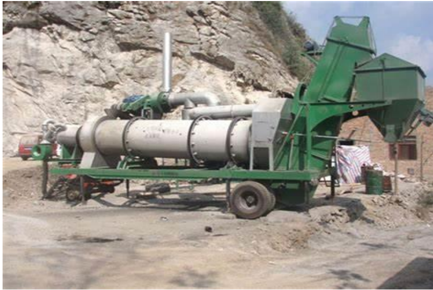
Figura 6.7 Tambor secador mezclador.
