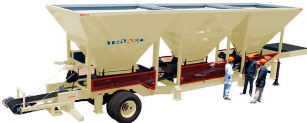
Figura 6.10 Unidad de tolvas triple con su banda recolectora desplegada.
