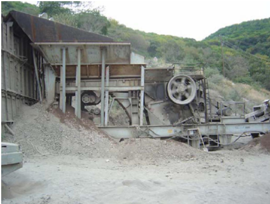
Figura 5.3 Vista exterior de una trituradora de quijadas en la cual se aprecia el volante que acciona la quijada móvil.
