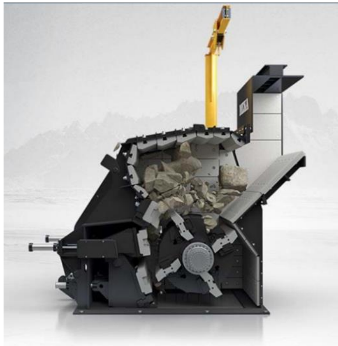
Figura 5.10 Vista interior de una trituradora de impacto.
