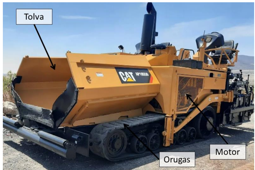
Figura 4.4 Partes delanteras de una finisher modelo AP1055D de la marca Caterpillar.
