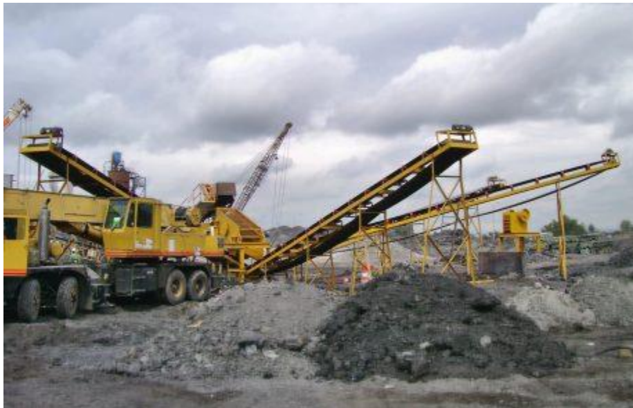
Figura 5.18 Bandas transportadoras para una planta de producción de agregados pétreos. Fuente: https://www.trituracionymolienda.com.mx/bandas/
