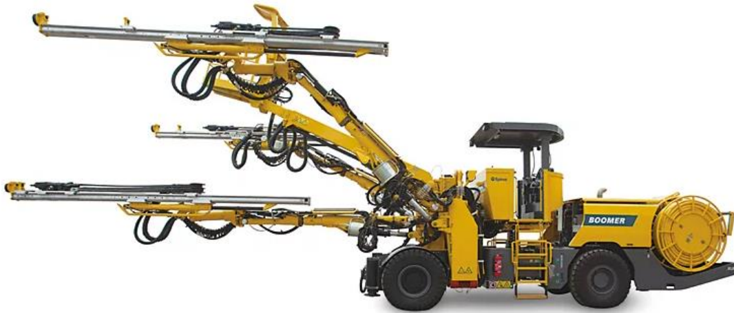
Figura 1.10 Jumbo de perforación Boomer XL3D.
