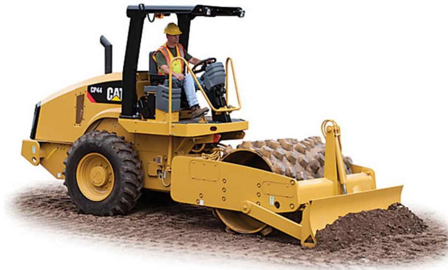
Figura 9.5 Compactador de rodillo vibratorio con pisones.
