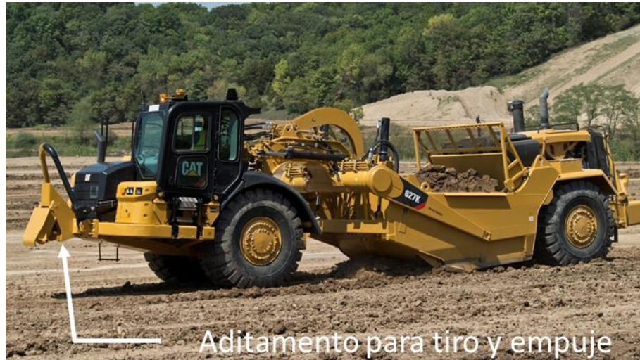
Figura 8.6 Motoescropa equipada con aditamento para tiro y empuje. Fuente: maquinariayconstruccion.bolgspot.com
