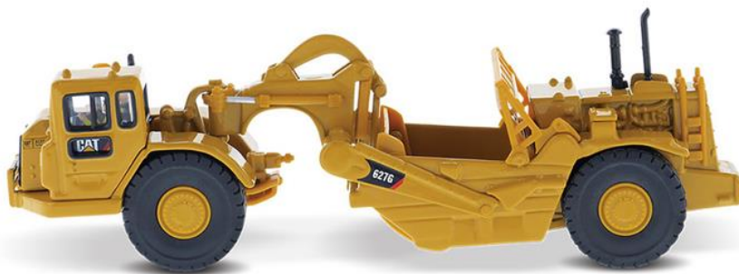
Figura 8.5 Motoescrepa con doble motor.
