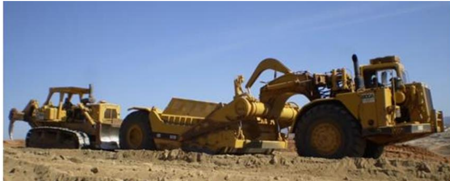
Figura 8.4 Motoescrepa estándar en carga con tractor empujador.
