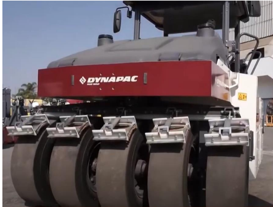
Figura 9.8 Raspadores para evitar que el material por compactar se adhiera a los neumáticos.
