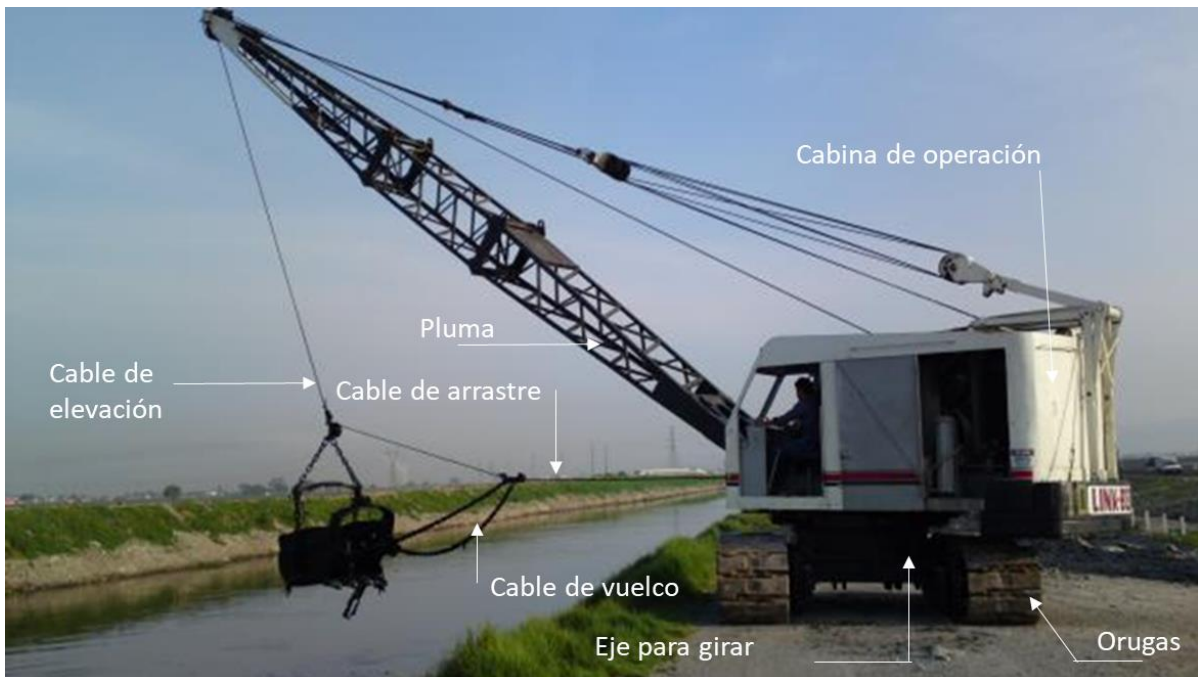
Figura 4.1 Partes principales de la draga de arrastre. Fuente: maquinariayconstruccion.blogspot.com Letreros: elaboración propia.
