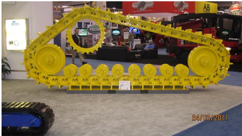
Figura 1.4 Sistema de orugas, zapatas, ruedas guía, rueda motriz y roles.
