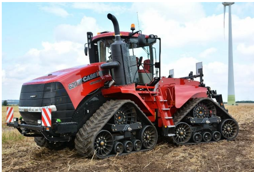
Figura 1.12. Tractor agrícola con sistema de orugas quadtrac.
