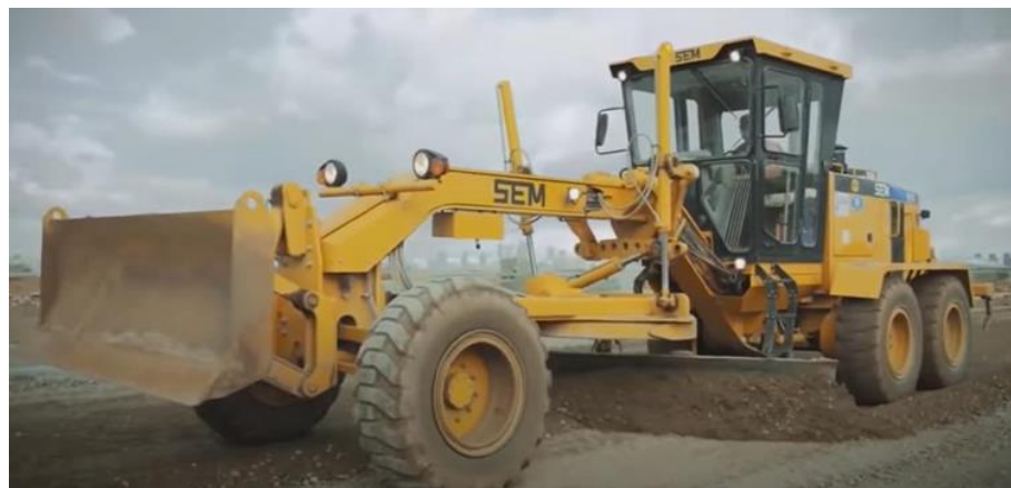
Figura 4.2 Motoconformadora equipada con vertedera y hoja frontal. Fuente: https://www.youtube.com/watch?v=aYR9yv1yejg
