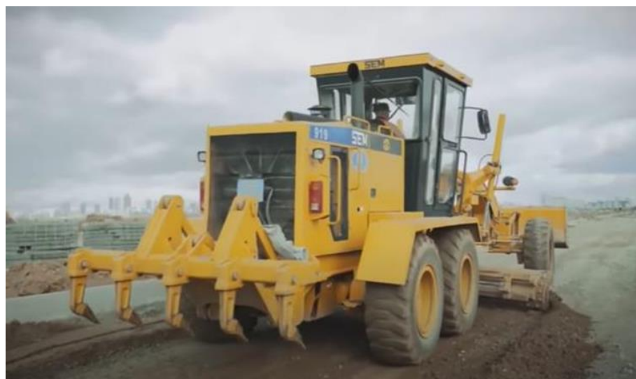
Figura 4.3 Motoconformadora equipada con Ripper. Fuente: https://www.youtube.com/watch?v=aYR9yv1yejg
