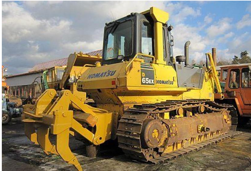
Figura 1.7. Tractor equipado con ripper de tres dientes.
