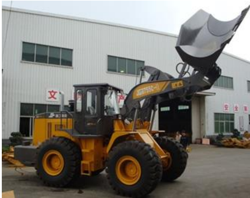
Figura 2.13 Cargador equipado con bote de descarga lateral.
