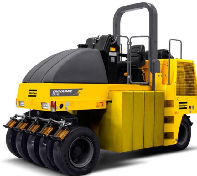
Figura 9.9 Compactador de neumáticos de la marca Dynapac, equipado con contrapesos.
