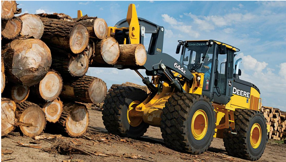
Figura 2.11 Cargador con horquillas para manipular troncos. Fuente: www.deere.com.ar
