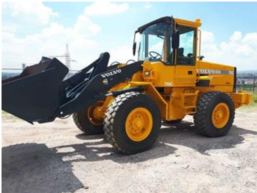
Figura 2.12 Cargador equipado con bote de descarga frontal.
