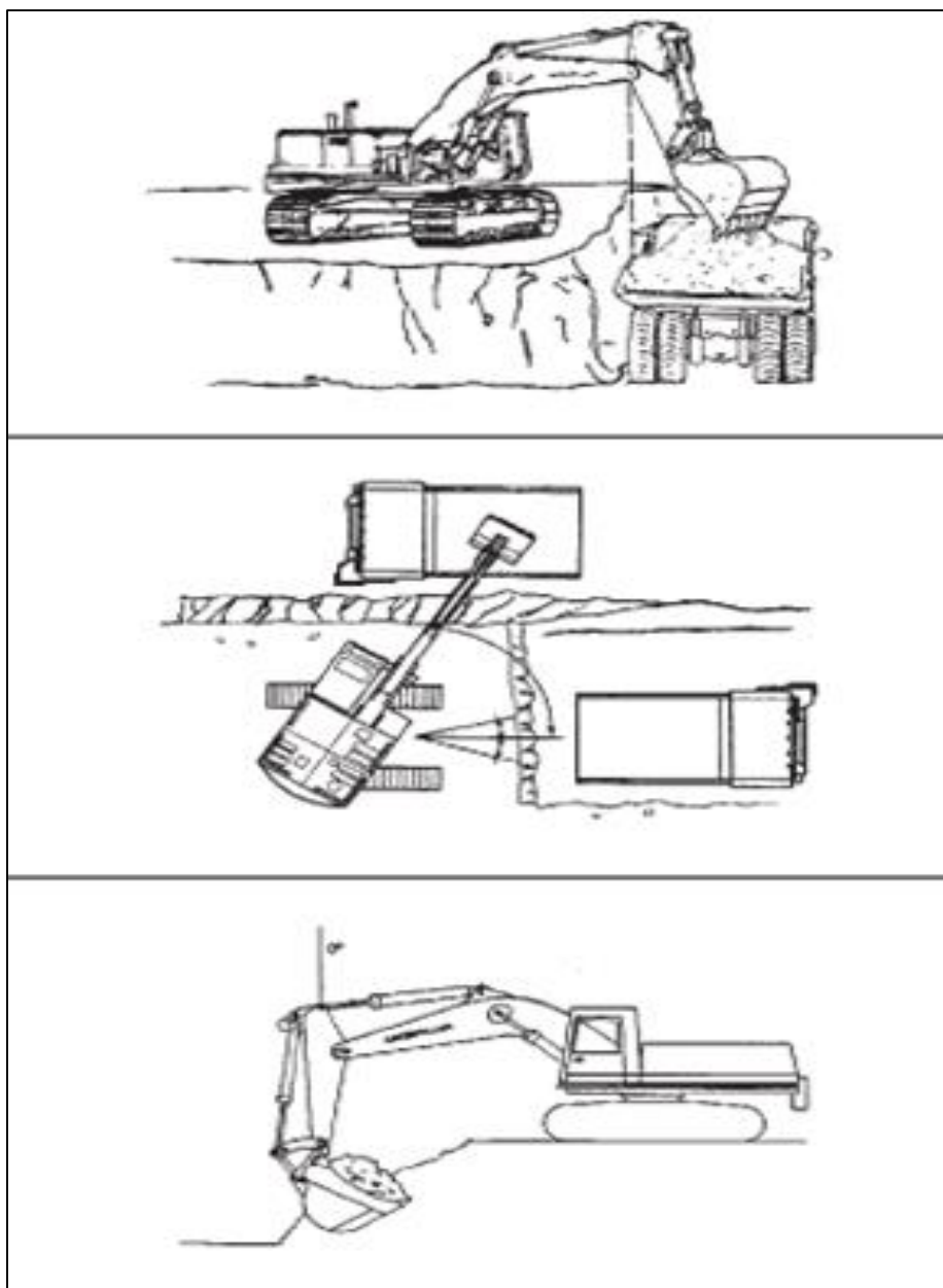
Figura 3.6 Ciclo de trabajo de una excavadora.
