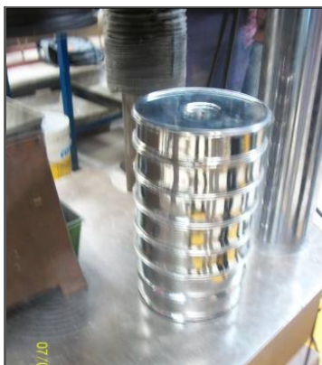
1.6 Cribas para ensaye de granulometría.
