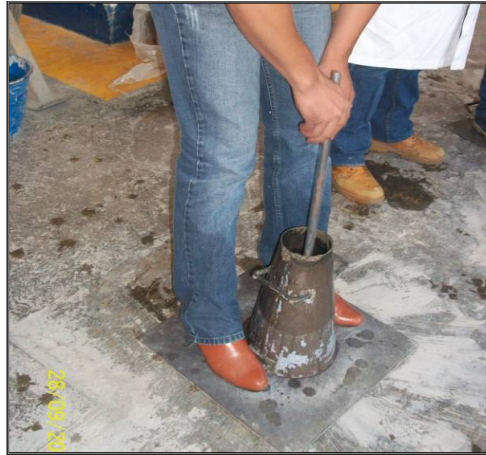
1.4 Compactación de la primera capa con la varilla especificada.
