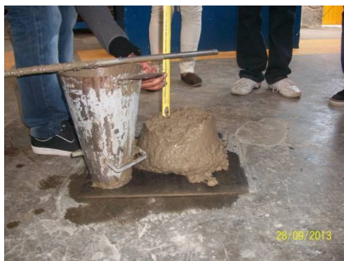
1.4 Medición del revenimiento en el concreto con aditivo.
