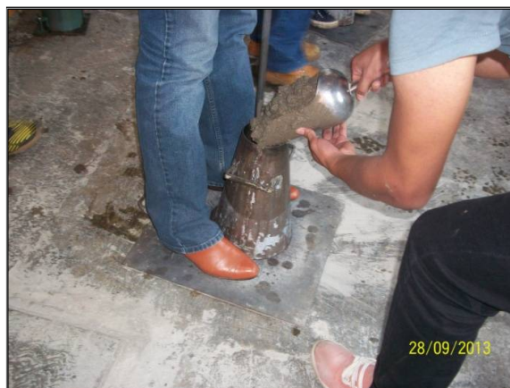
1.3 Llenado del cono truncado de revenimiento.
