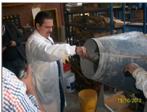
1.3 Aplicación de aditivo a la mezcla de concreto.
