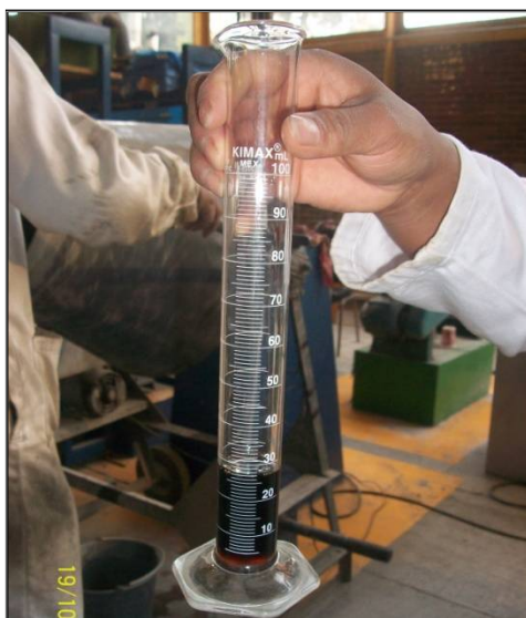
Fig. 1.2 Dosificación del aditivo con base en el peso del cemento.
