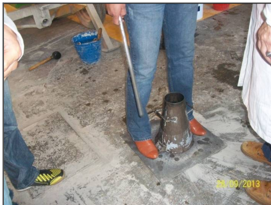
Fig. 1.2 Inicio de la prueba de revenimiento.
