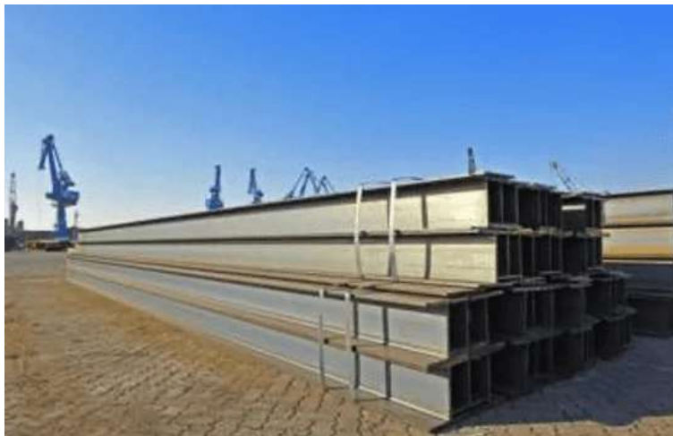
Figura 6. Pilotes de acero
