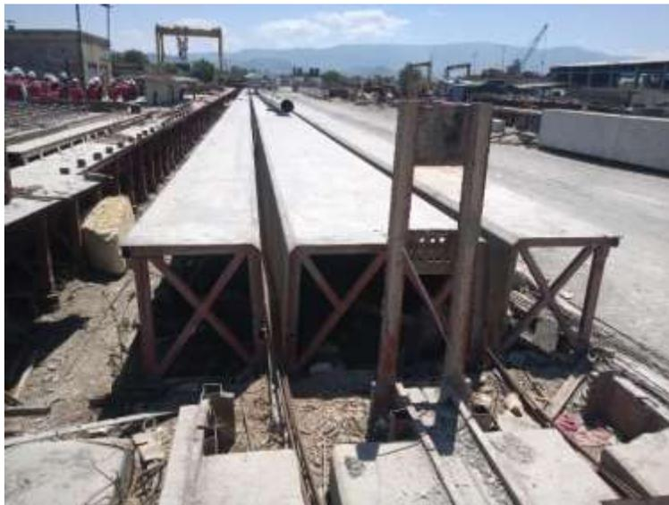
*Nota: Moldes metálicos para fabricación de losa TT en Planta GSA, Texcoco [Fotografía], por Departamento de Construcción, abril de 2024. Colección personal del autor.*
