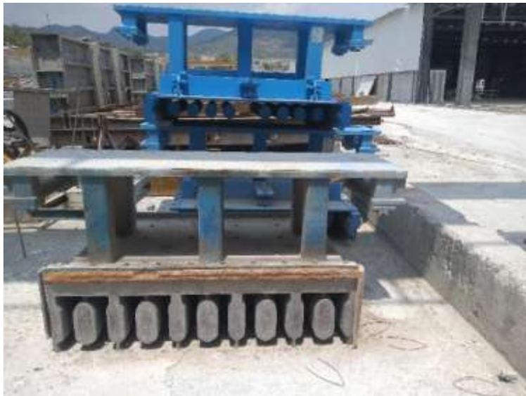
*Nota:* Moldes metálicos para fabricación de losa alveolar en Planta CEMPOSA, Tepetzotlán [Fotografía], por Departamento de Construcción, abril de 2024. Colección personal del autor.
