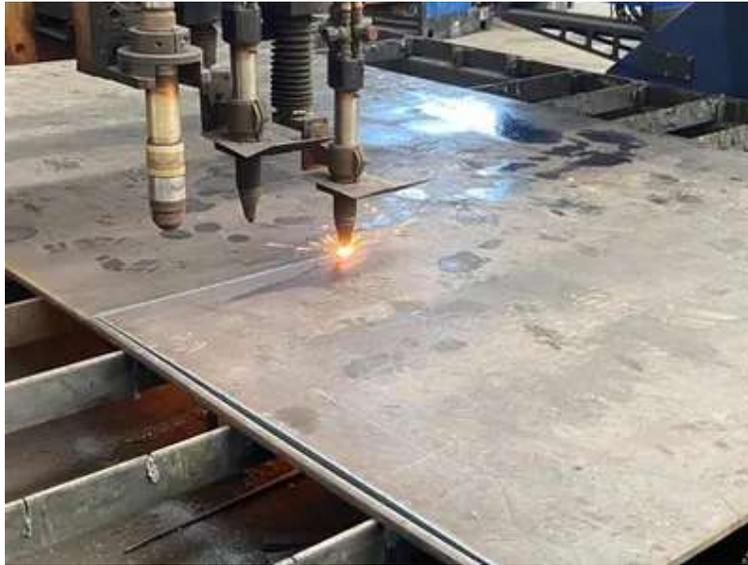
*Nota:* Adaptada de *Corte de placa con Plasma en pantógrafo* [Fotografía], por Aceros Poltech, 2024, Poltech (<https://poltech.mx/corte-de-placa-pantografo>). Todos los derechos reservados.
