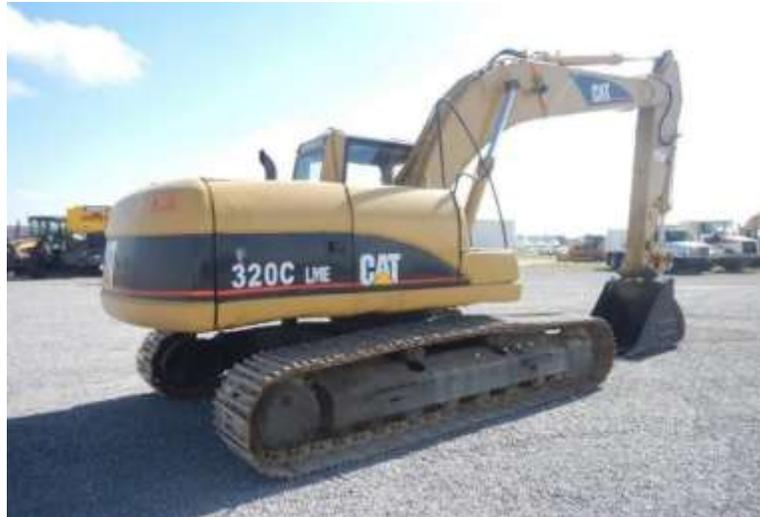
Figura 3.4 Excavadora hidráulica sobre orugas.
