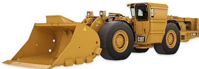
*Figura 2.4 Cargador frontal de bajo perfil.*
