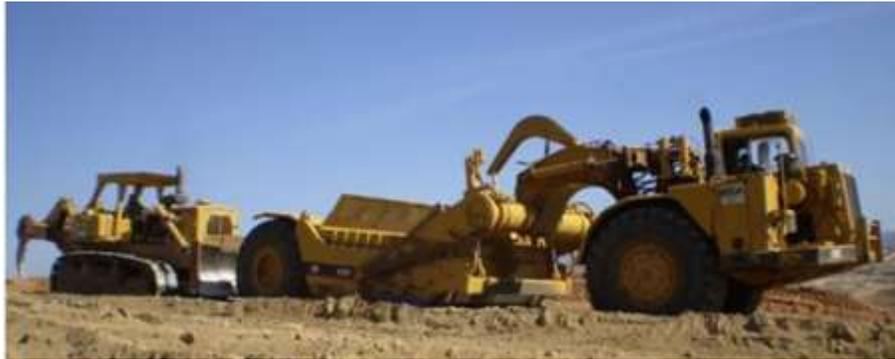
*Figura 8.4 Motoescrepa estándar en carga con tractor empujador.*
