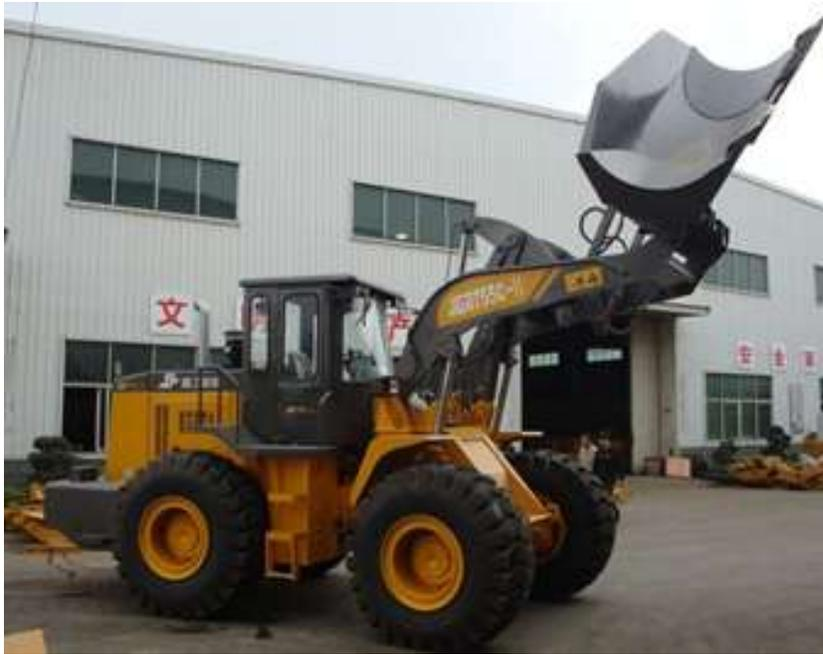
*Figura 2.13 Cargador equipado con bote de descarga lateral.*
