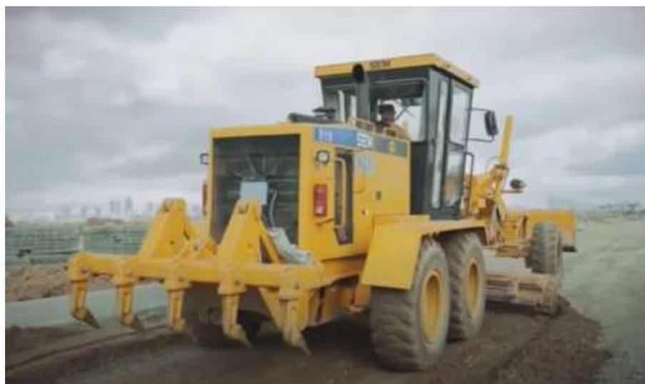
*Figura 4.3 Motoconformadora equipada con Ripper.
