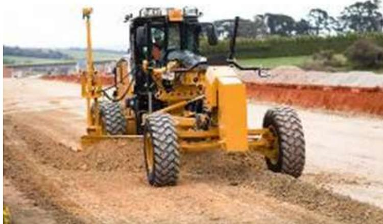
*Figura 4.4 Motoconformadora extendiendo material.*
