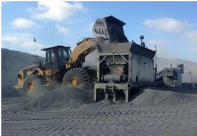
Figura 2.16 Cargador frontal en trabajo de acarreo.
