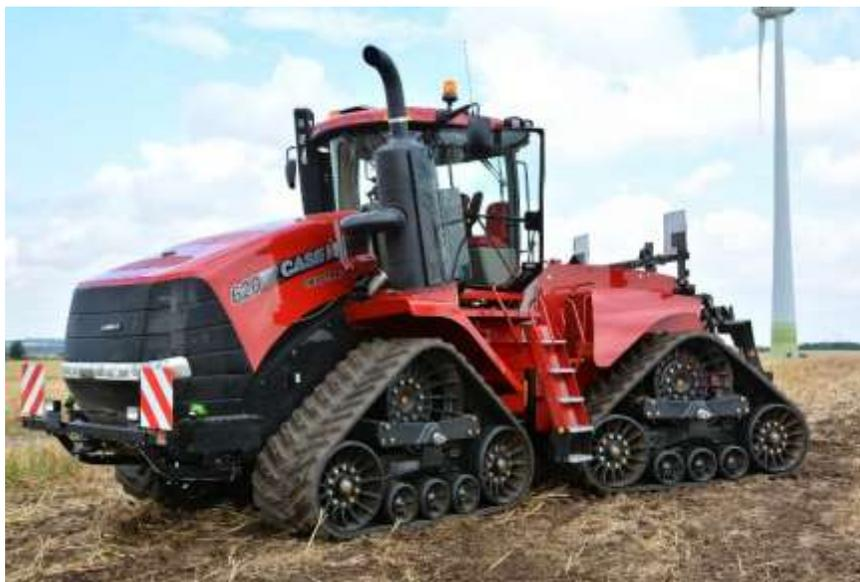
*Figura 1.12. Tractor agrícola con sistema de orugas quadtrac.*
