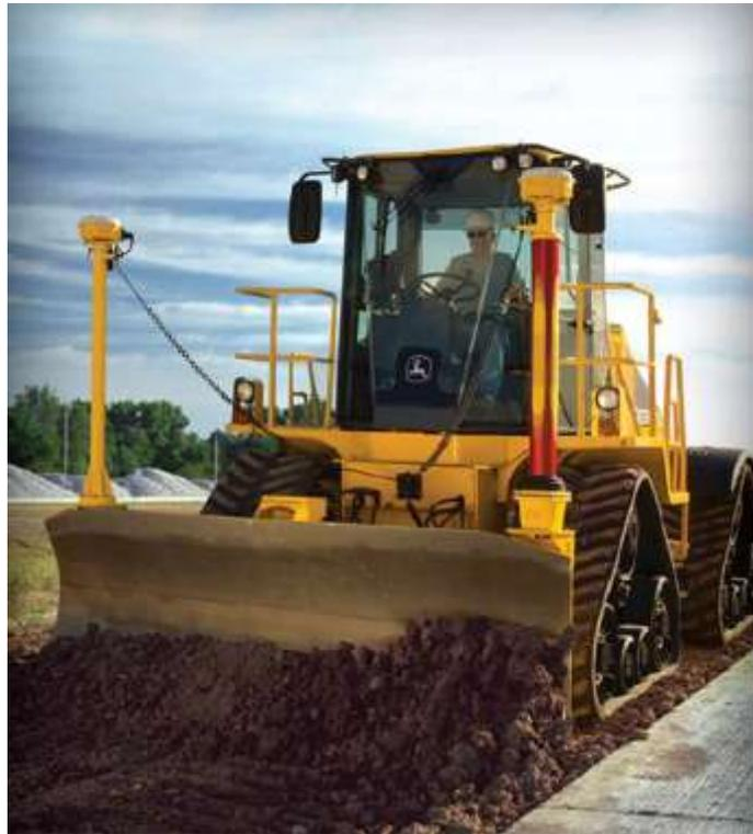
*Figura 1.13. Sistema cuádruple de orugas. Fuente: Catálogo de productos John Deere*
