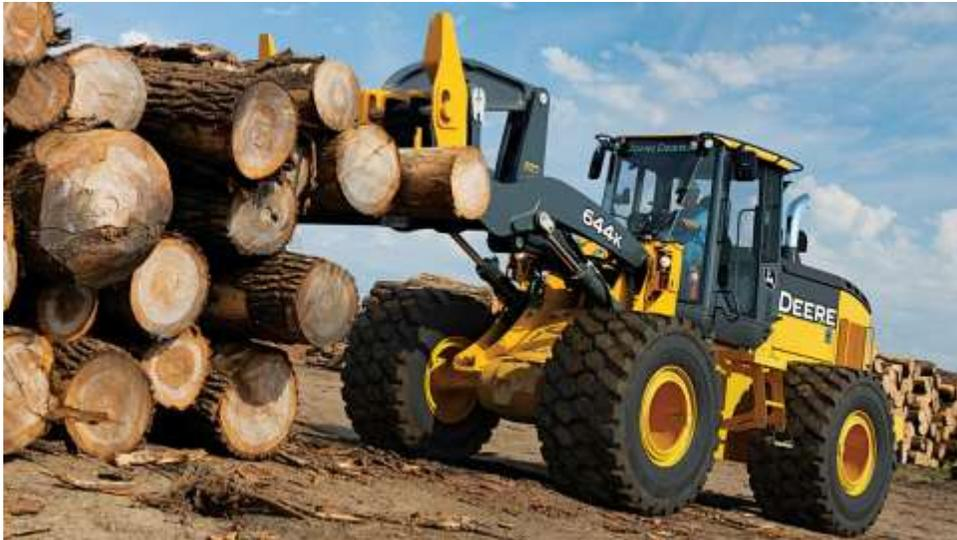
*Figura 2.11 Cargador con horquillas para manipular troncos. Fuente: [www.deere.com.ar](http://www.deere.com.ar)*
