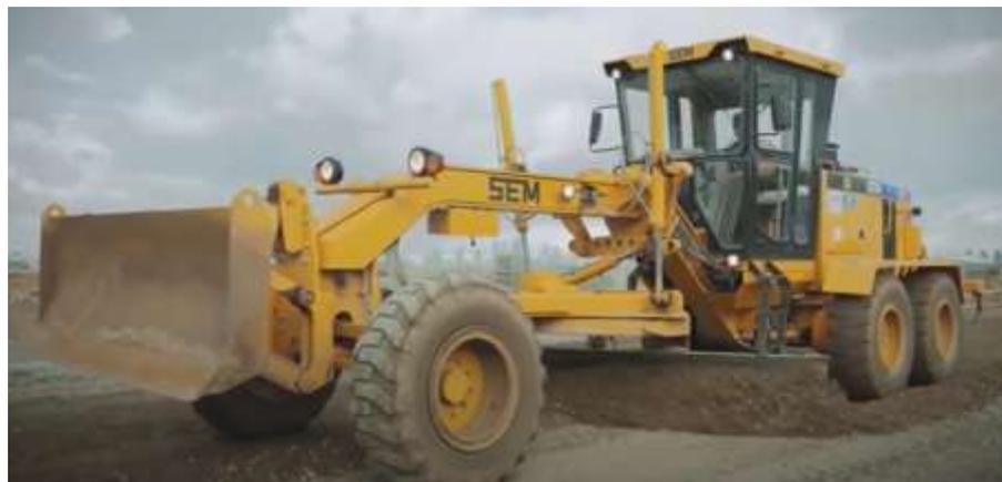
*Figura 4.2 Motoconformadora equipada con vertedera y hoja frontal.
