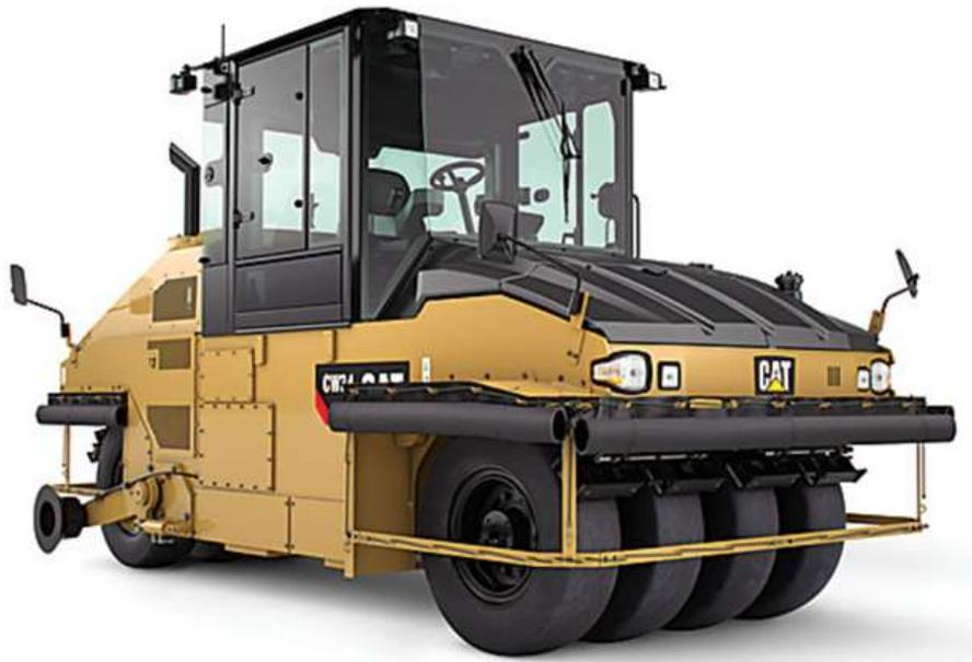
*Figura 9.7 Compactador de neumáticos.*
