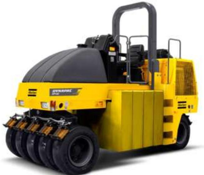
*Figura 9.9 Compactador de neumáticos de la marca Dynapac, equipado con contrapesos.*
