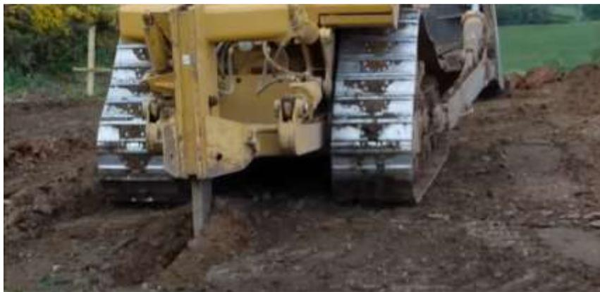
*Figura 1.15. Tractor en operación de rippear o desgarrar material.*
