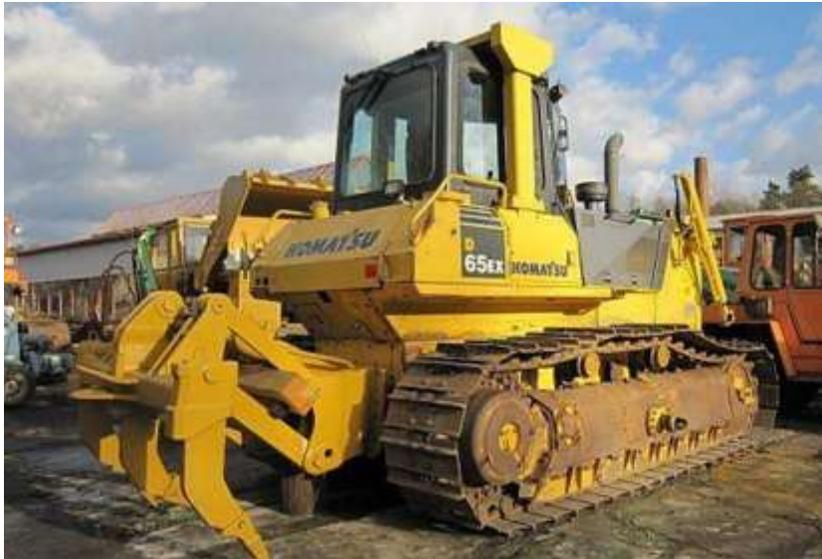
Figura 1.7. Tractor equipado con ripper de tres dientes.
