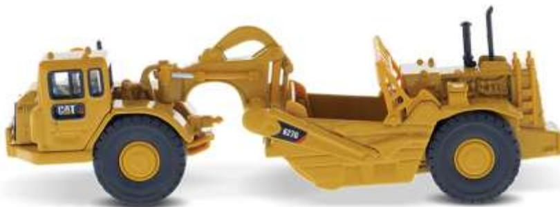
*Figura 8.5 Motoescrepa con doble motor.*
