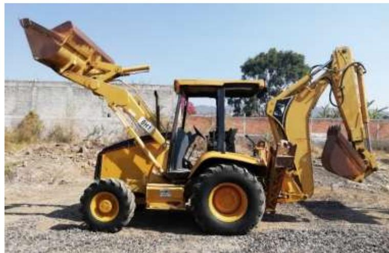
*Figura 3.2 Retroexcavadora-cargadora.*
