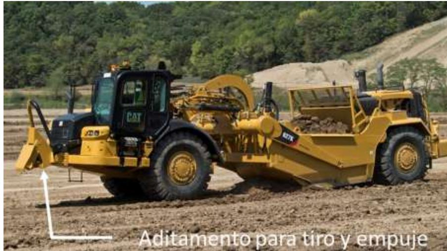
*Figura 8.6 Motoescropa equipada con aditamento para tiro y empuje.
