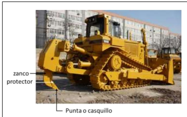
Figura 1.6. Tractor equipado con ripper de un solo diente.
