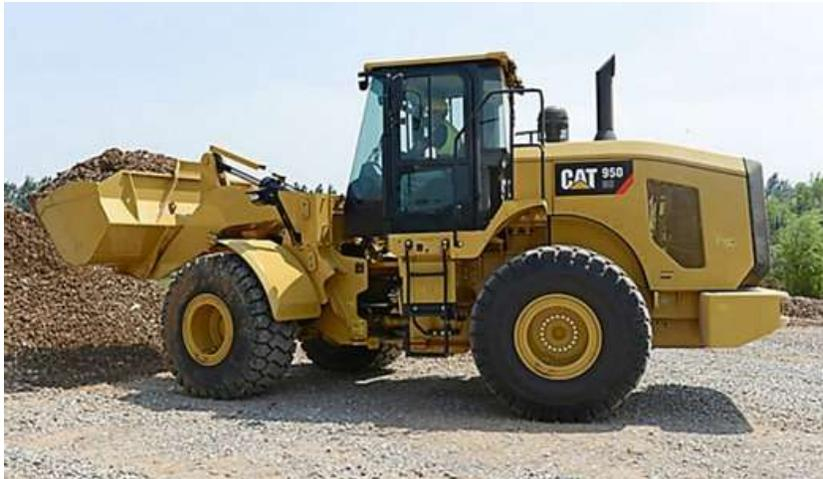
*Figura 2.3 Cargador frontal sobre llantas.*
