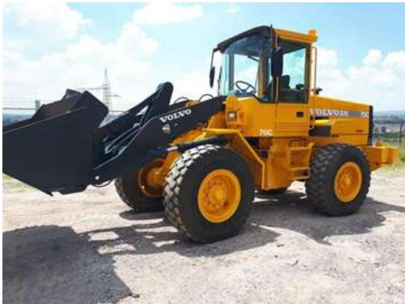
*Figura 2.12 Cargador equipado con bote de descarga frontal.*
