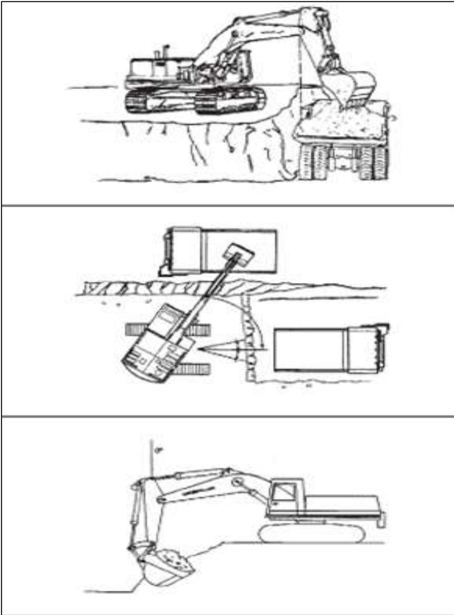
Figura 3.6 Ciclo de trabajo de una excavadora.
