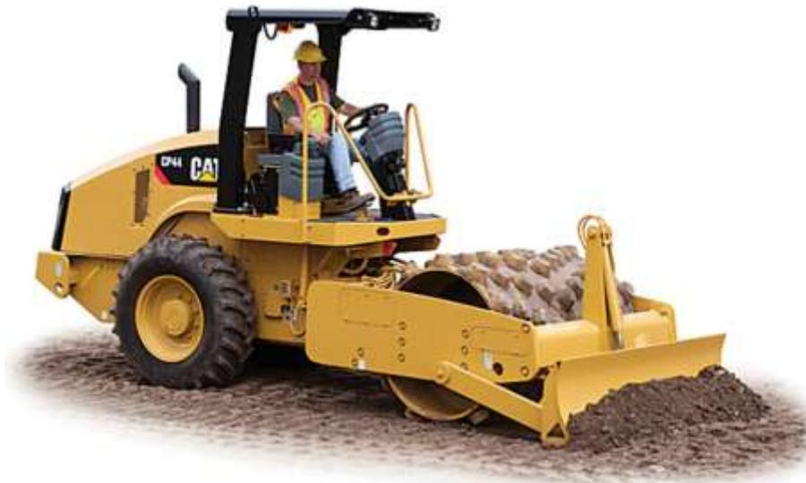
*Figura 9.5 Compactador de rodillo vibratorio con pisones.*
