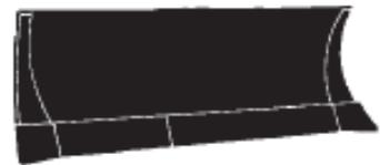
**Hoja "C"** — Esta hoja amortiguada se usa para el empuje y carga de traíllas sobre la marcha. Los tacos de caucho absorben los impactos al hacer contacto con el bloque de empuje de la traílla. Es también útil en conservación y en trabajos generales de empuje. El bastidor en "C" estrecho aumenta la maniobrabilidad de la máquina en zonas de corte congestionadas y reduce el riesgo de dañar los neumáticos como con las hojas SU y U.
