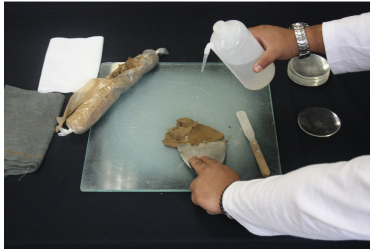
Figura 5. Remoldeo e hidratación del material.
