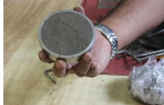
Figura 11. Muestra dentro de anillo.
