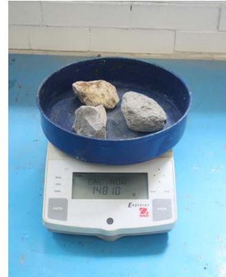
Figura 8. Obtención de masa de material retenido.
