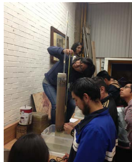
Pruebas de permeámetro de carga constante y variable.
