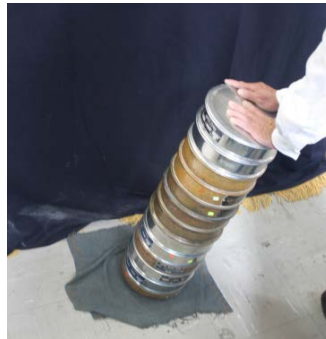
Figura 6. Agitado de mallas.
