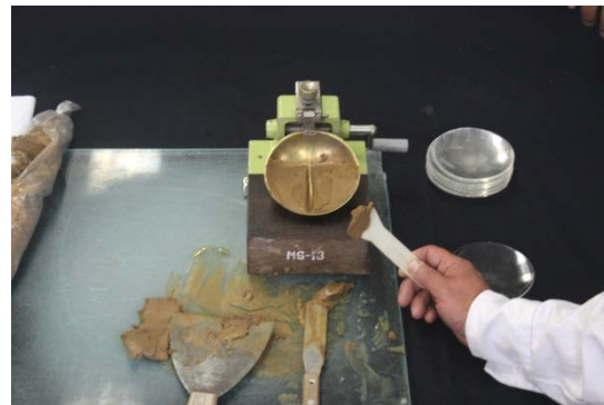
Figura 8. Ranura en el material.
