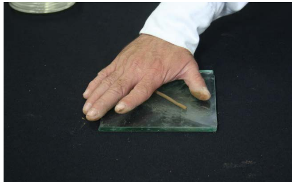
Figura 13. Rodamiento del cilindro.
