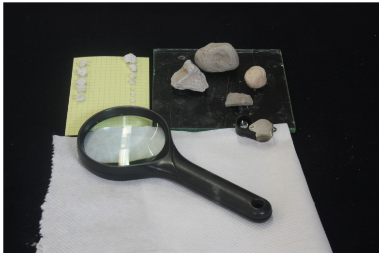
Figura 2. Identificación de suelos gruesos por su tamaño.
