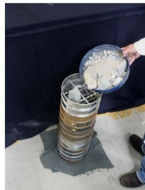
Figura 4. Vaciado de material en el sistema de mallas
