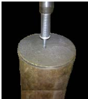
Figura 4. Prueba de penetrómetro de bolsillo.
