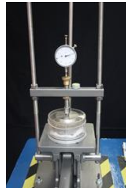
Figura 18. Montaje en consolidómetro.
