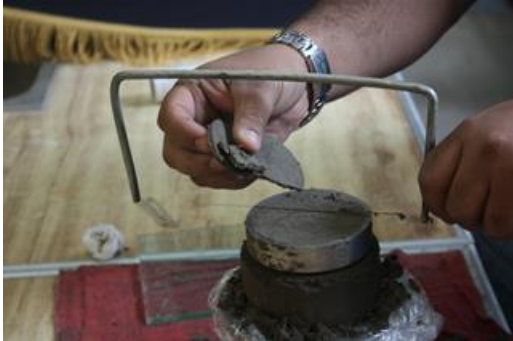
Figura 10. Corte de enrasado.
