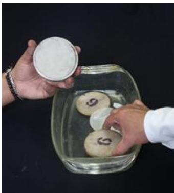
Figura 12. Colocación de papal filtro.
