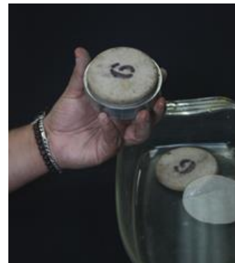
Figura 13. Colocación de piedra porosa.
