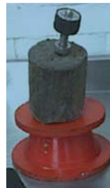
Figura 5. Prueba de torcómetro de bolsillo.
