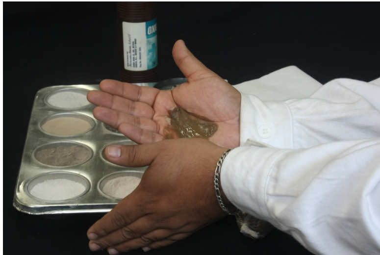
Figura 5. Prueba de dilatancia.
