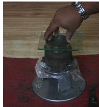
Figura 9. Introducción del anillo.
