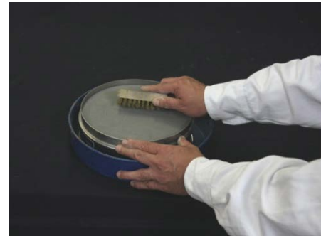
Figura 10. Liberando material atrapado.
