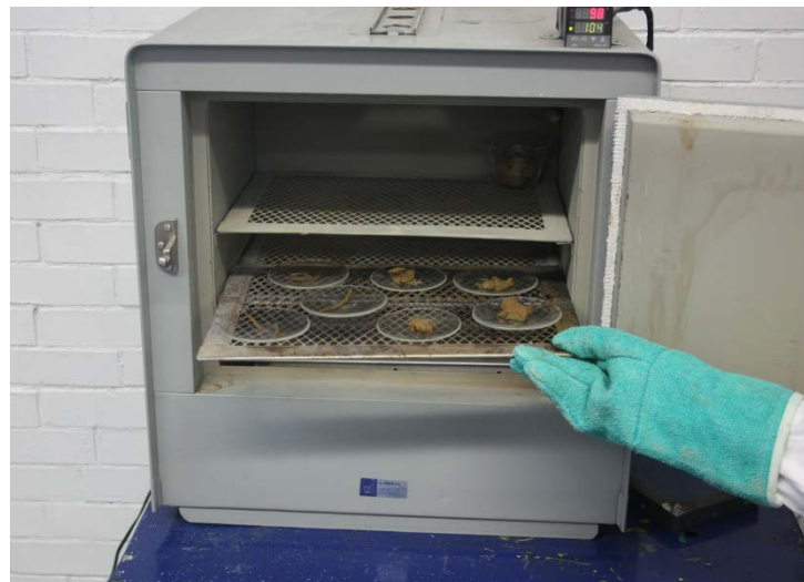
Figura 16. Muestras de suelo para secarlas al horno
