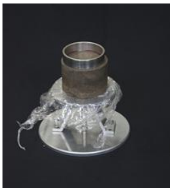
Figura 6. Anillo centrado en muestra.
