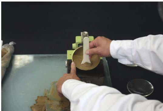
Figura 7. Colocación del ranurador
