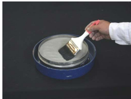
Figura 11. Limpiado con brocha la malla No. 200.
