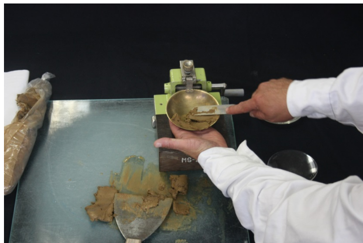
Figura 6. Colocación del material en la copa.
