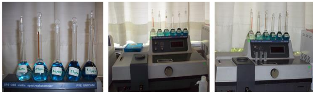
Figura 2. Reacción de indofenol e hipoclorito de sodio
