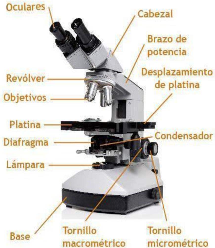
Figura 3. 1. Microscopio y sus componentes
