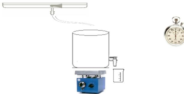
**Figura 1.1. Reactor de flujo continuo.**
