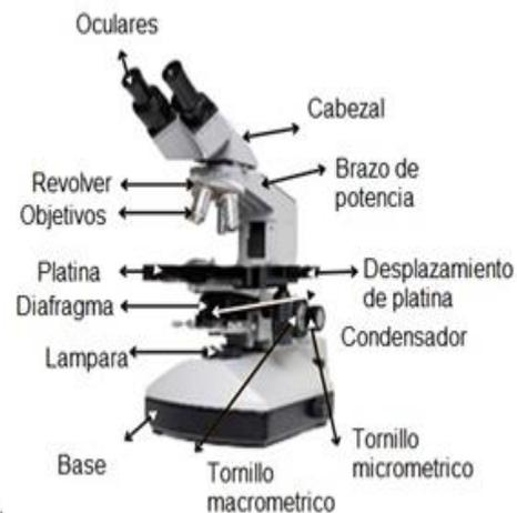
Figura 1.1 Microscopio y sus componentes.
