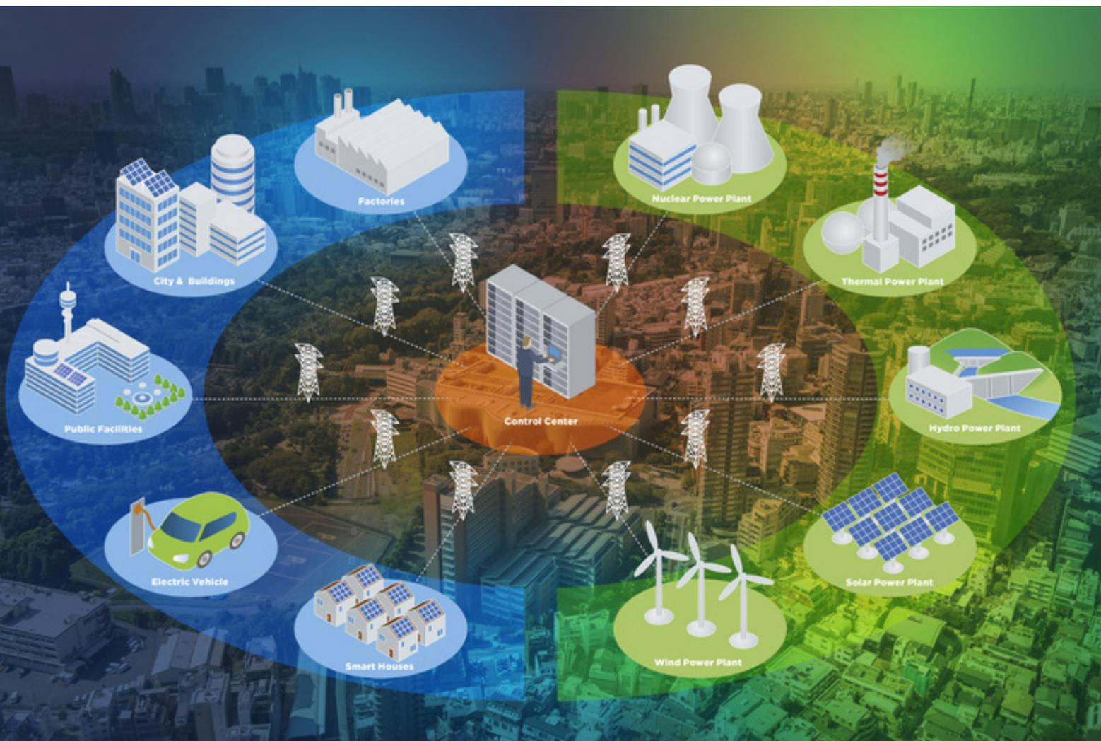
De esta manera, en la VPP se integran distintas fuentes de energías renovables para alimentar en conjunto una red eléctrica. Para lograrlo, la VPP ejecuta análisis de big data cuyos resultados le sirven de apoyo para gestionar de forma inteligente la energía en función de parámetros como las condiciones climáticas, los precios de los servicios, la localización de las instalaciones y de los usuarios finales, entre otros.
