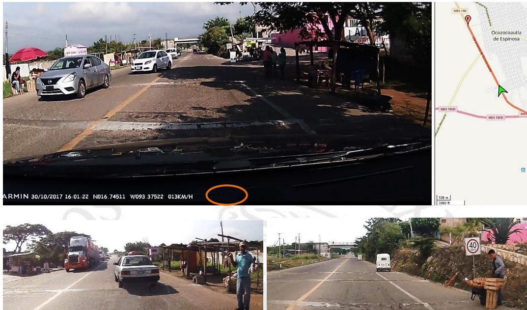
Figura 26. Velocidad de paso por los topes de 13 km/h en el km 3+100
